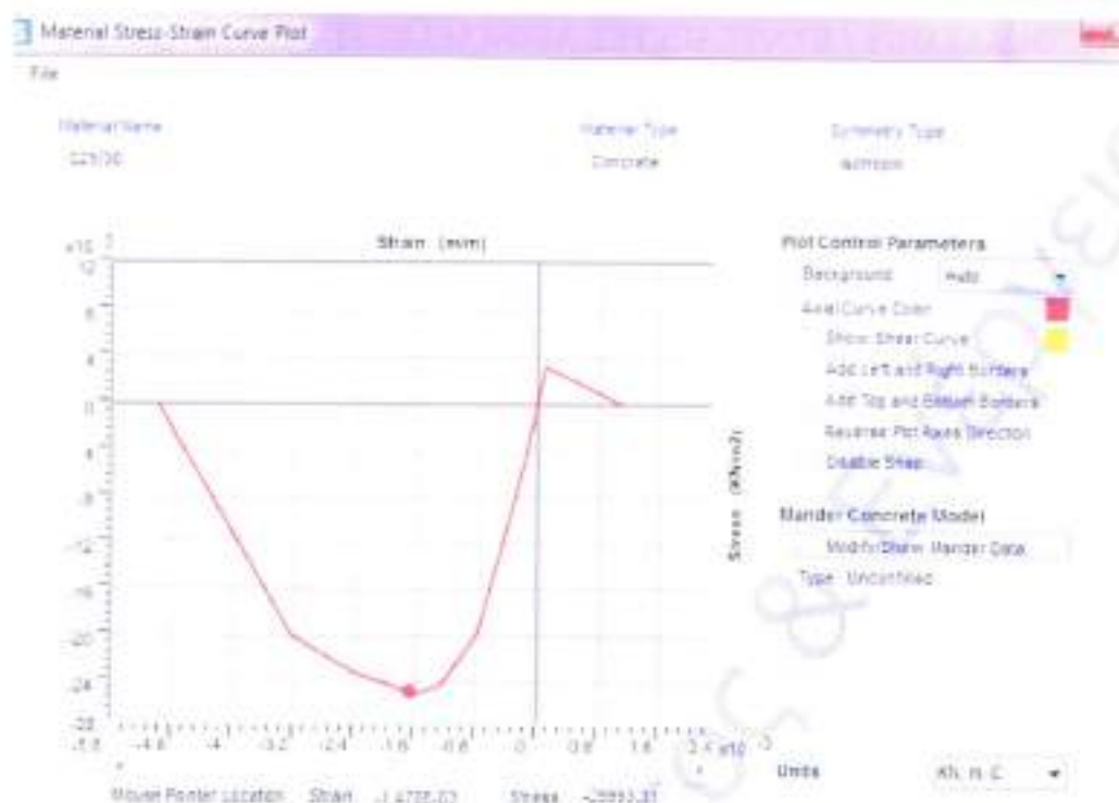
Εικόνα 3-4: Καταστατικός νόμος ( \sigma - \epsilon ) σκυροδέματος – νέων στοιχείων
